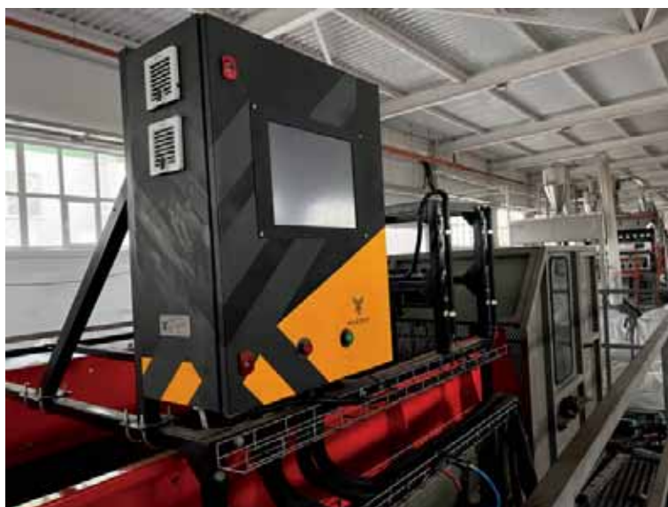
Рис. 2. Внешний вид сепаратора WINGSBEE, установленного на технологической линии мусоросортировочного комплекса.
