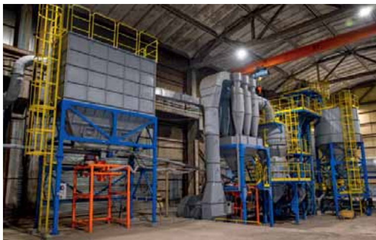
Рис. 3. Комплекс по измельчению отходов металлургических производств для получения минеральных порошков МП-2.
