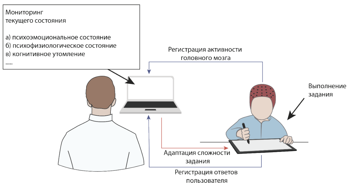
Рис. 1. Качественная иллюстрация концепции предлагаемой системы для персонализации траектории обучения на основе измерения когнитивных и личностных характеристик обучаемого с использованием нейроинтерфейса «мозг–компьютер» и методов искусственного интеллекта.
