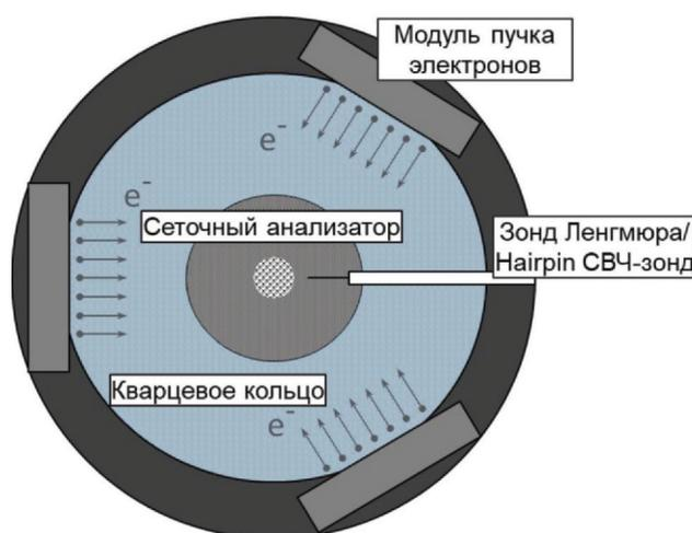
Рис. 2. Вид на разрядную камеру сверху.
