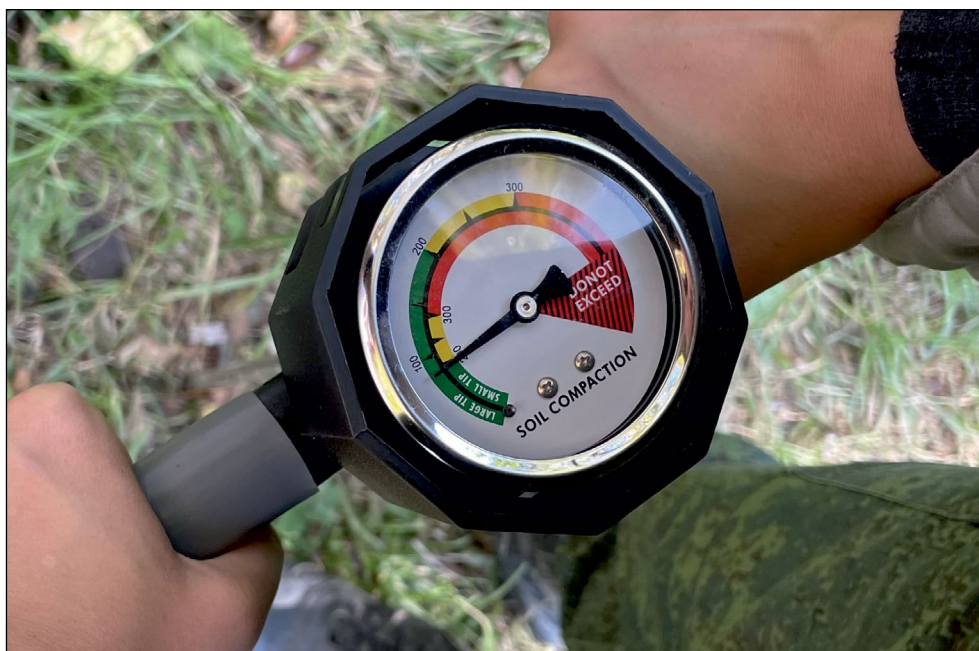
Рис. 2. Шкала плотности грунта плотномера Wile Soil
