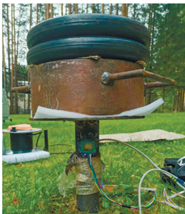
Рис. 2. Свая с грузом 61.5 кг на свободном конце и 3-осевым акселерометром в грунтовом массиве (а); 3-х осевой акселерометр на свободной части сваи (б).
