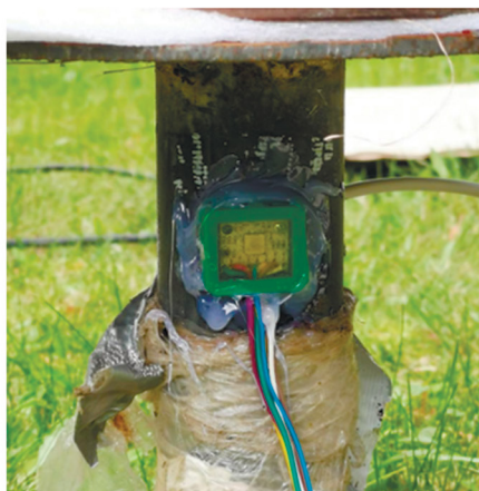
Рис. 2. Свая с грузом 61.5 кг на свободном конце и 3-осевым акселерометром в грунтовом массиве (а); 3-х осевой акселерометр на свободной части сваи (б).
