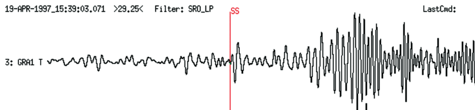
Рис. 4. Типичная сейсмограмма; землетрясение вблизи острова Северная земля, произошедшее 19 апреля 1997 [11]; красной линией отмечено начало прихода S-волн.
