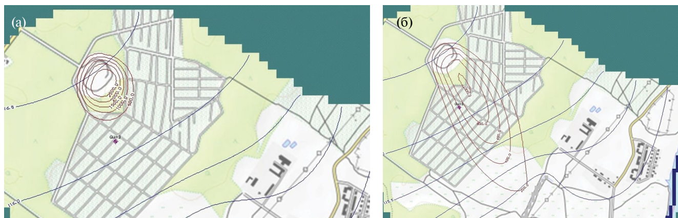
Рис. 13. Изолинии концентрации хлорид-иона (мг/л) в пласте после рекультивации свалочного тела через: а – 10 лет, б – 50 лет.
