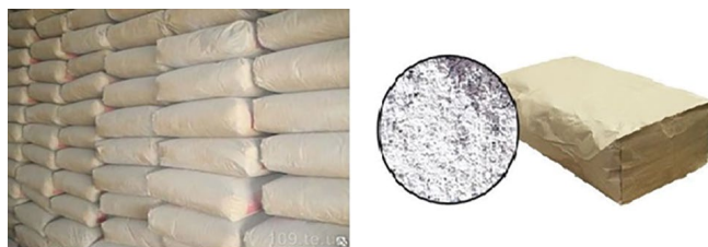
Рис. 1. Пример неправильной упаковки без маркировки тары хризотилового асбеста.
