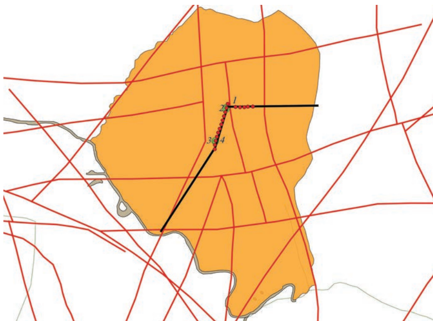
Рис. 6. Схема расположения объекта моделирования с системой разломов (красные линии). Скважины: закачки – красные кружки, наблюдательные – зеленые; цифры – номера скважин. Линия разреза показана черным цветом.
