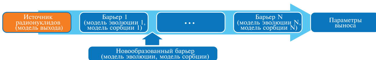
Рис. 1. Схема формирования интегральной модели прохождения поллютанта сквозь каскад эволюционирующих барьеров безопасности.
