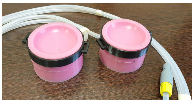
Рис. 2. Пьезокерамические датчики, используемые в исследовании
