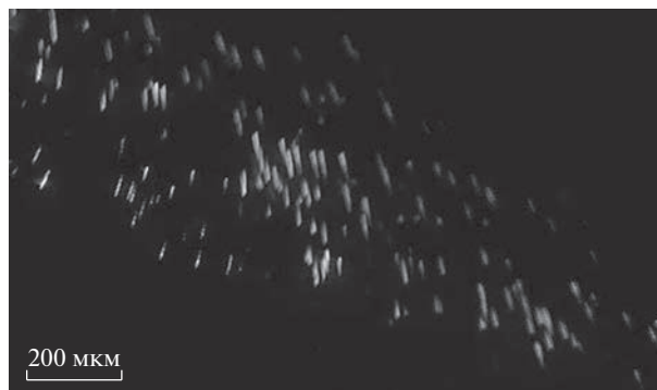
Рис. 7. Типичный фрагмент видеокadre наблюдения аэрозольных частиц с помощью горизонтального микроскопа
