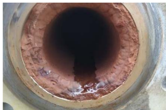
Фиг. 1. Фотография настывлей в разгрузочной трубе (исходный диаметр 150 мм) одного из автоклавов ПАГК
