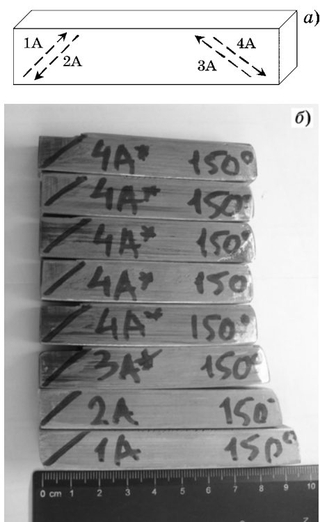
Фиг. 1. Схема деформации при РКУП (а) и общий вид образцов, изготовленных при 150 °С (б)
