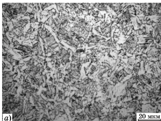
Фиг. 1. Микроструктура исследуемой стали в состояниях после ТО (а) и КП + УО (б) [13]
