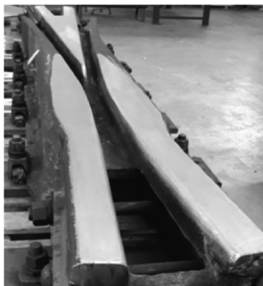
Фиг. 3. Фотография крестовины в экспериментальном цехе после создания покрытия
