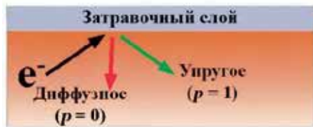
Рис. 5. Поверхностное рассеяние электронов (а) может быть упругим и диффузным. Для преобладания упругого рассеяния требуется (б) атомарно гладкая поверхность и диэлектрический затравочный слой с низкой плотностью локализованных состояний (в).
