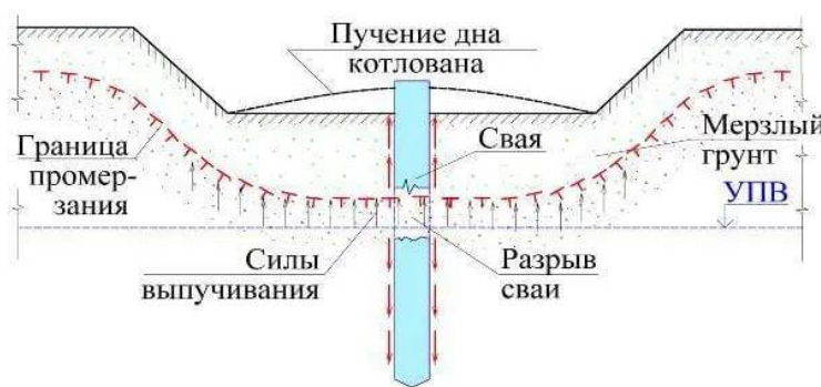
Рис. 1. Процесс разрыва свайных опор при выпучивании
