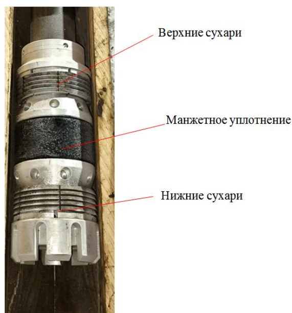
Рис. 4. Проблемные элементы при разбухании пакер-пробки
