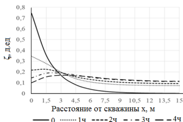
Рис. 4. Изменение количества осадка в объеме пор \zeta(x, t) за 4 часа виброимпульсного воздействия
