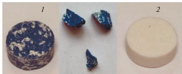
Рис. 2. Вид керамики LATP после ИПС (1) и после пост-отжига на воздухе (2).
