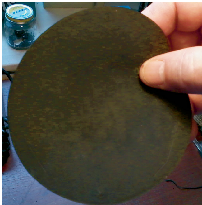
Рис. 1. Типичный образец нанобумаги для электрохимических измерений.
