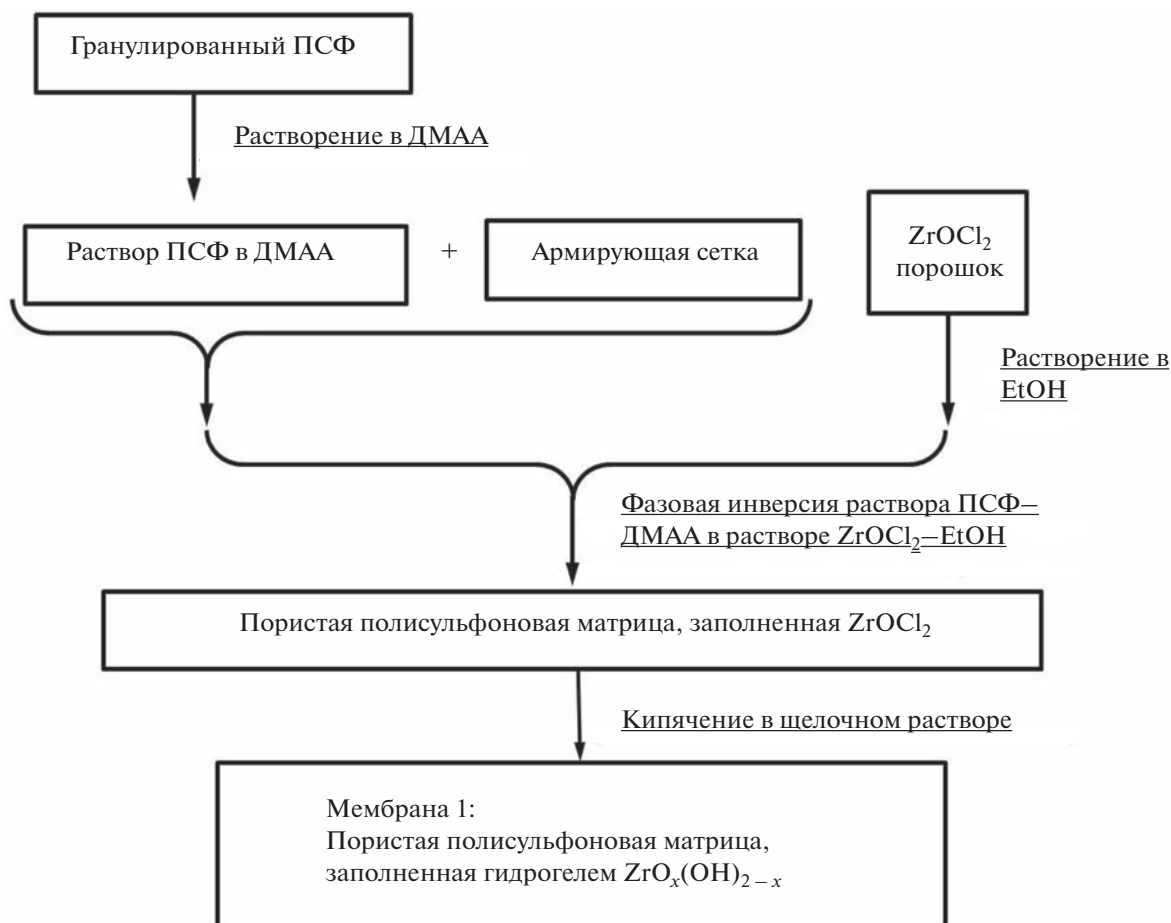
Рис. 2. Схема синтеза мембран первого типа с порами, заполненными гидрогелем гидроксида циркония.
