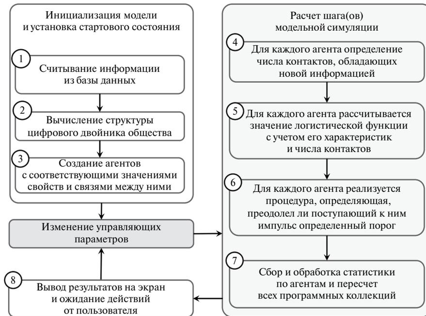
Рис. 2. Концептуальная схема работы модели
