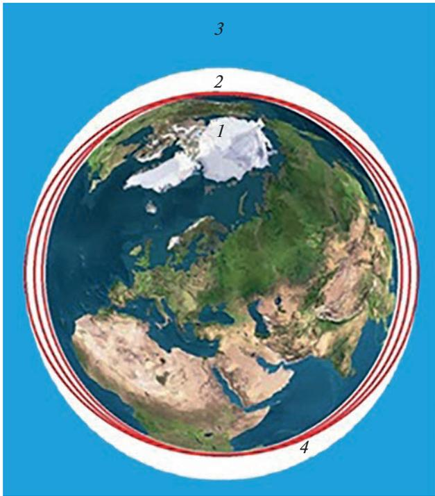
**Рис. 2.** Иллюстрация стоячей электромагнитной волны в волноводе Земля–ионосфера. 1 – Земля  $R \approx 6400$  км, 2 – зазор  $h \approx 80$  км со слабо ионизированной атмосферой, 3 – ионосфера, 4 – символическое изображение пространственно-локализованной в зазоре (2) стоячей электромагнитной волны, узлы и пучности которой находятся в электромагнитном пространстве.
