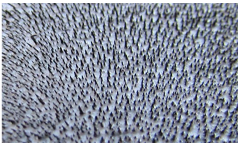
Рис. 4. Структура поверхности после полимеризации жидкой пленки МАЭ в магнитном поле.
