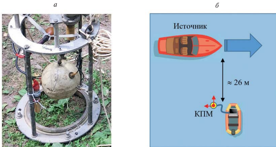
Рис. 2. Используемый в эксперименте комбинированный приемный модуль (КПМ) (а); условная схема проведенных измерений на гидроакустическом полигоне МГУ с движущимся катером (б).
