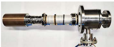
Рис. 2. Внешний вид экспериментального макета релятивистского сильноточного гиротрона.
