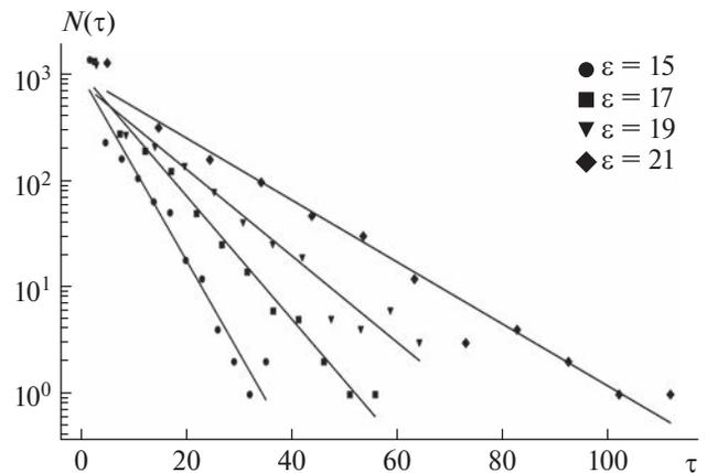
Рис. 1. Распределения длительностей ламинарных фаз  $N(\tau)$  двух одинаправленно связанных систем Лоренца (5), полученные при различных значениях параметра связи  $\varepsilon$ , и соответствующие им аппроксимации экспоненциальным законом (3):  $\varepsilon = 15$  (●),  $\varepsilon = 17$  (■),  $\varepsilon = 19$  (▼),  $\varepsilon = 21$  (◆).
