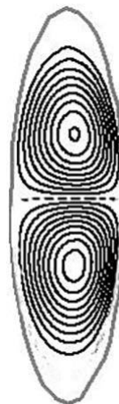
Рис. 14. Изолинии полоидального магнитного потока в плазме с вертикальным расположением магнитных осей.
