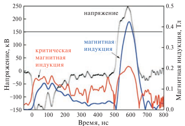
Рис. 9. Осциллограмма ускоряющего напряжения, расчетные значения магнитной индукции в А-К-зазоре и критической магнитной индукции.
