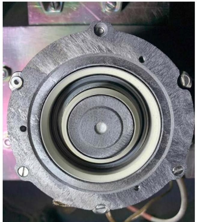
Рис. 33. Вид торцевой поверхности EM HT-1000 после 200-часовых эрозионных испытаний.
