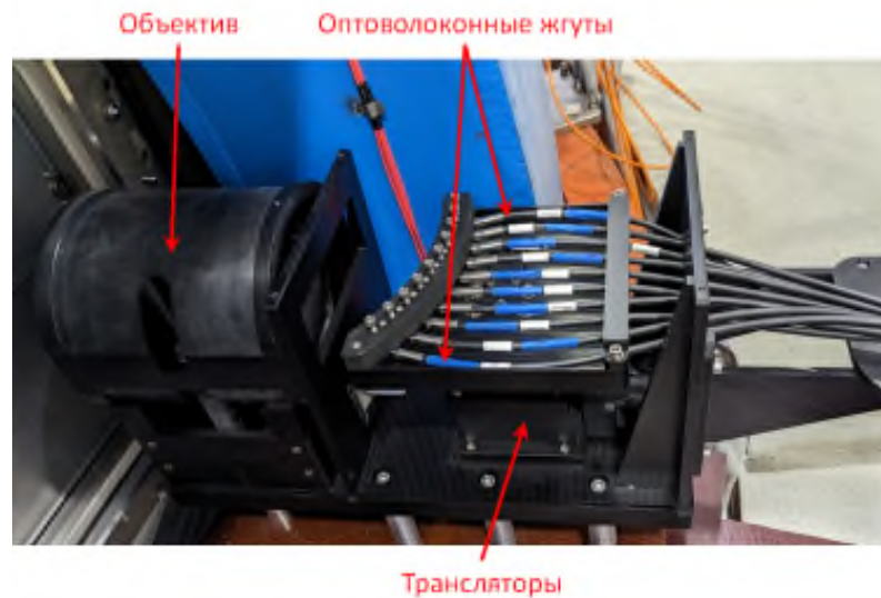
Рис. 3. Расположение узла сбора света на фланце токамака.
