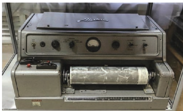
Рис. 2. Фототелевизионное устройство ввода изображений в ЭВМ БЭСМ-4 на базе фототелеграфного аппарата “Нева”.
