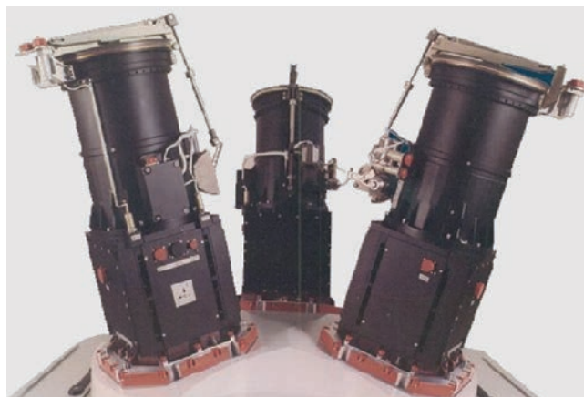
Рис. 3. Система оптических звездных датчиков “Астро”.
