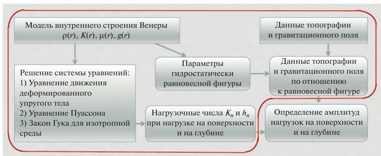
Рис. 2. Блок-схема расчета вариаций толщины коры методом чисел Лява.
