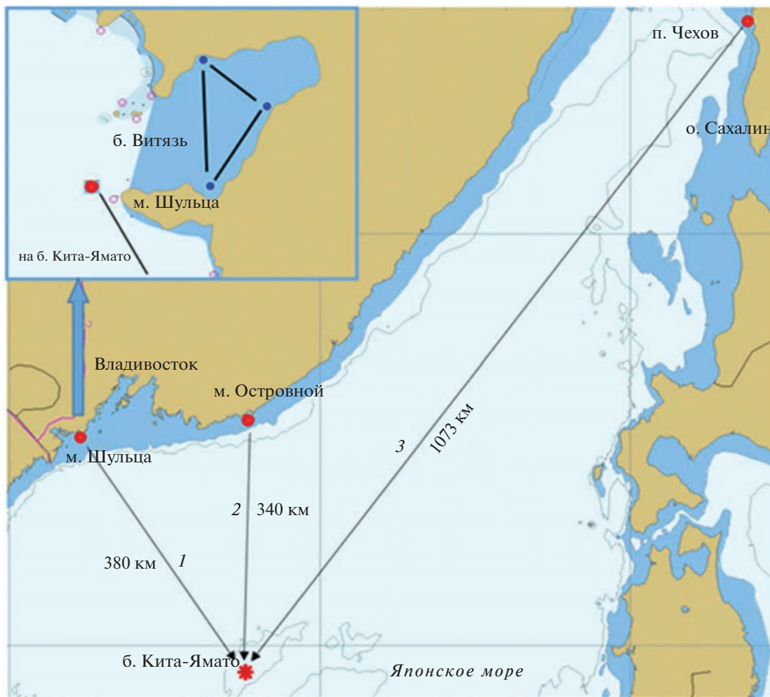
Рис. 1. Измерительная система для исследования и контроля температурных режимов в Японском море.
