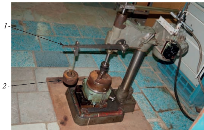
Рис. 1. Общий вид модельной установки: 1 – рычаг нагрузки; 2 – грузы.
