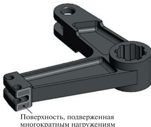
Рис. 1. Поверхность детали, подверженная многократным нагрузкам.
