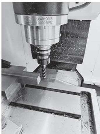
Рис. 2. Процесс обработки поверхности боковой частью концевой фрезы.
