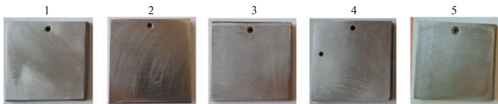
Рис. 4. Защитные свойства сульфонатных смазок в камере повышенной влажности: 1 – К-313; 2 – К-314; 3 – ССК-400; 4 – ССК-400D; 5 – Lubrizol 86 GR.
