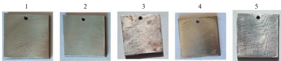
Рис. 7. Фотографии пластин после длительных испытаний сульфонатных смазок в морской воде: 1 – К-313; 2 – К-314; 3 – ССК-400; 4 – ССК-400D; 5 – Lubrizol 86 GR.
