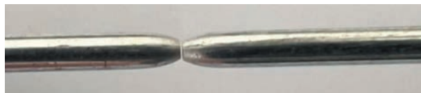
Рис. 3. Вид шейки образца на растяжение перед разрушением.
