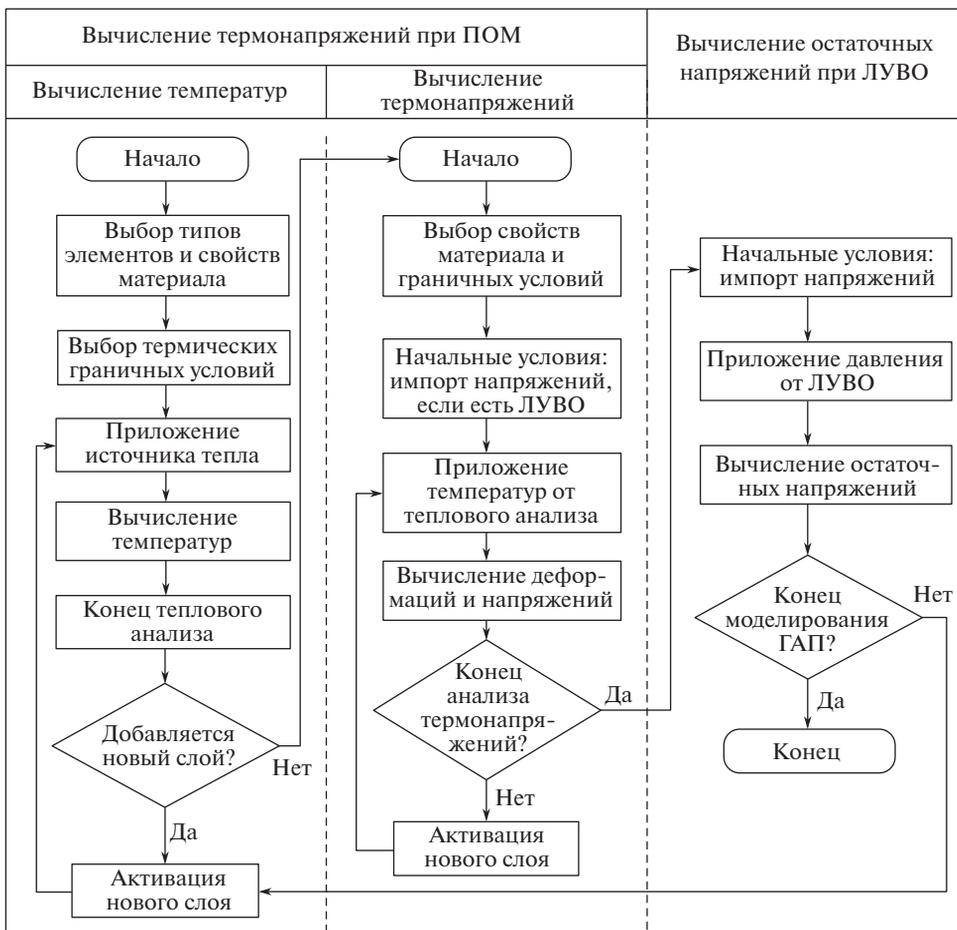
**Рис. 3.** Блок-схема моделирования ГАТ с использованием ЛУВО.
