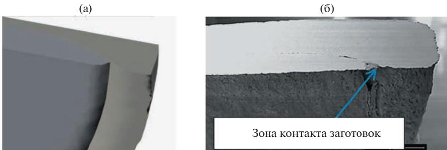
**Рис. 10.** Сравнение результатов моделирования и осадки пакета из двух заготовок из сплава БрX08: (а) – моделирование (92%); (б) – эксперимент.
