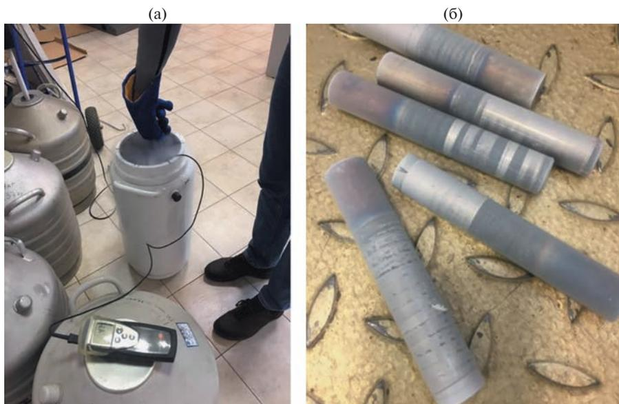
**Рис. 4.** Исследования по влиянию низких температур на изменение полученных свойств поверхностного слоя после комбинированной обработки: (а) – проведение эксперимента; (б) – образцы после обработки в смеси воды и спирта в кипящем азоте.
