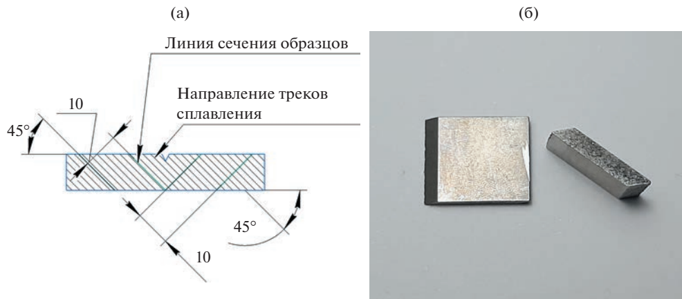
Рис. 3. Пробоподготовка образцов: (а) – схема сечений исследуемых синтезированных образцов; (б) – подготовленный срез толщиной 2 мм.
