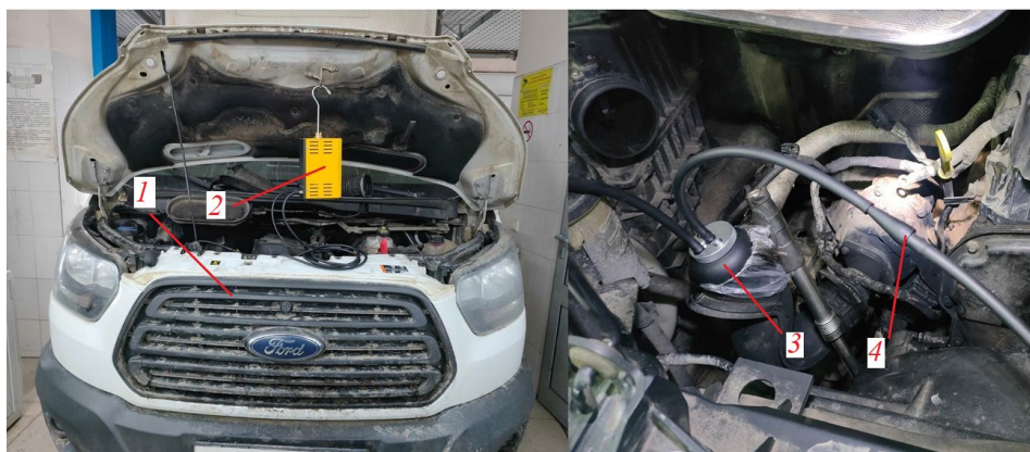
Рис. 3. Оценка технического состояния системы впуска: 1 — радиатор охлаждения с интеркулером; 2 — устройство для оценки состояния системы впуска; 3 — заглушка впускного патрубка интеркулера; 4 — шланг подачи воздуха.
