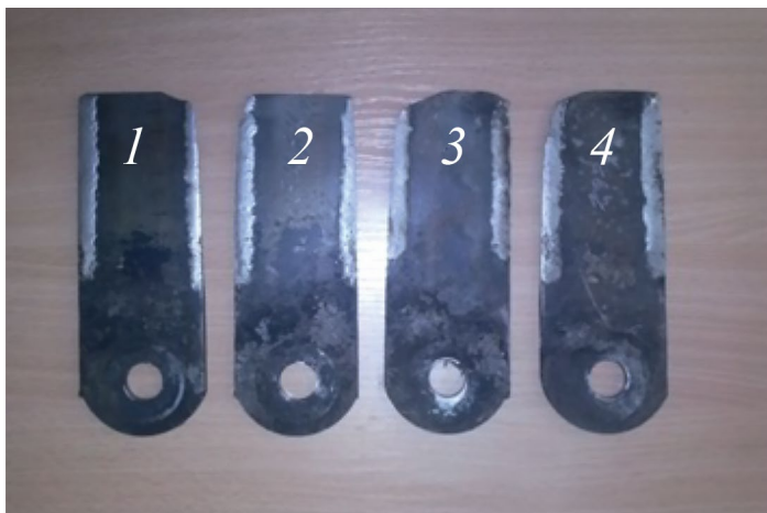
Рис. 1. Внешний вид изношенных контрольных ножей измельчителя-разбрасывателя комбайна Acros при различной наработке, га: 1 – 47; 2 – 110; 3 – 162; 4 – 225.
