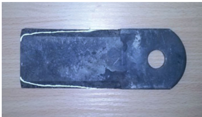
Рис. 3. Контур преимущественной фигуры износа ножа.
