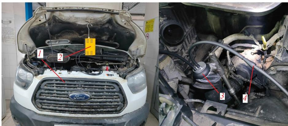
**Рис. 3.** Оценка технического состояния системы впуска: 1 — радиатор охлаждения с интеркулером; 2 — устройство для оценки состояния системы впуска; 3 — заглушка впускного патрубка интеркулера; 4 — шланг подачи воздуха.
