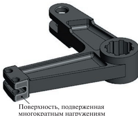
Рис. 1. Поверхность детали, подверженная многократным нагрузкам.
