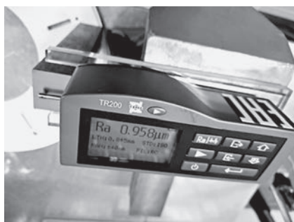
Рис. 3. Измерение шероховатости профилометром мод. TR200.
