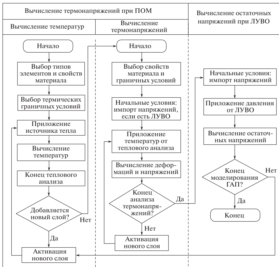
Рис. 3. Блок-схема моделирования ГАТ с использованием ЛУВО.
