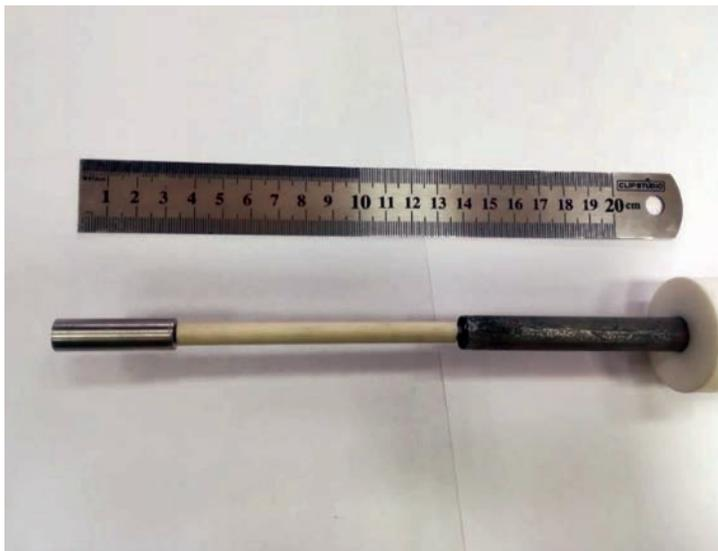
Рис. 4. Внешний вид катодной сборки (катод – слева).
