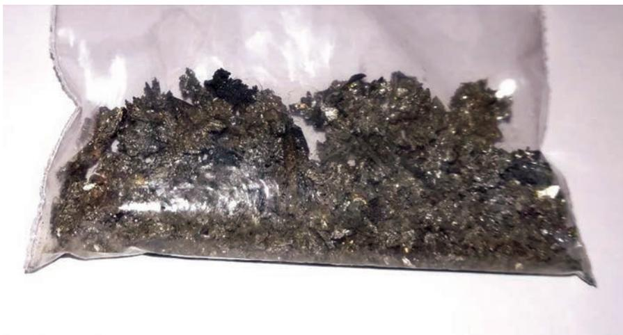
Рис. 5. Внешний вид отмытого катодного урана, направляемого в инертный бокс.
