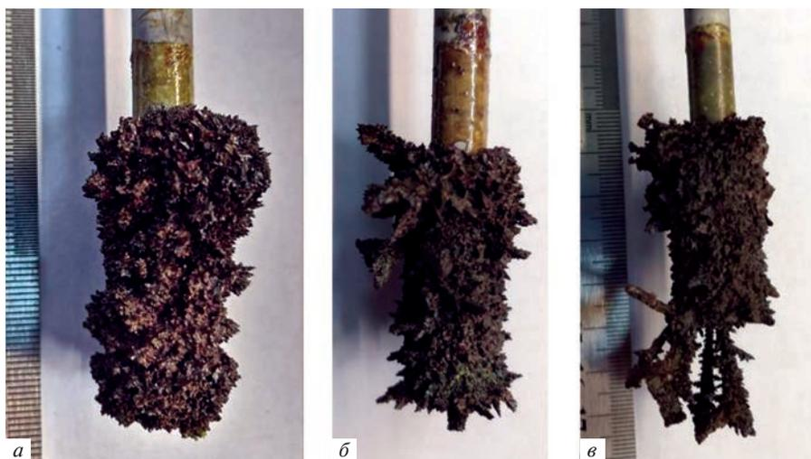
**Рис. 6.** Фотографии катодных осадков, полученных в ходе электрорафинирования U–Pd сплава с содержанием Pd в общей массе анода 1.58 мас. % при различных начальных катодных плотностях тока: *a* – 0.1; *б* – 0.2; *в* – 0.4 А/см<sup>2</sup>.
