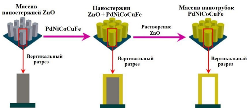
Рис. 9. Схема изготовления нанотрубок ВЭС PdNiCoCuFe методом темплатного электроосаждения [89].
