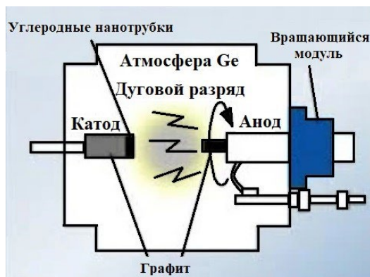
Рис. 5. Схема установки для синтеза НЧ-ВЭС методом дугового разряда [73]
