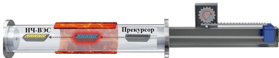
Рис. 1. Принципиальная схема экспериментальной установки ПБДС для синтеза НЧ-ВЭС [59].
