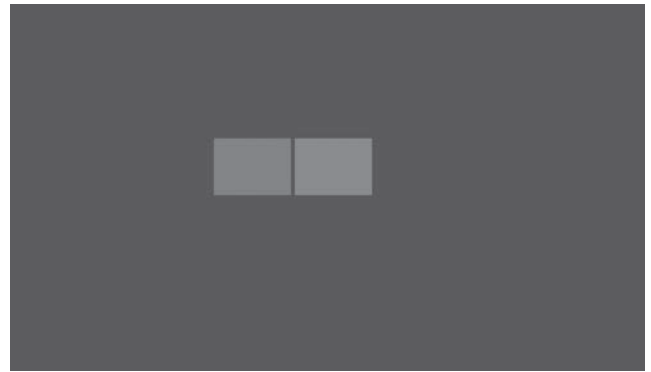
Рис. 1. Общий вид предъявляемого изображения, около 60 см по диагонали, для обнаружения более темного поля из двух смежных полей на изображении. Контраст между смежными полями на рисунке g = 0.038 (10 бит); в тестировании использовались контрасты 0, 1 и 2 бита.
