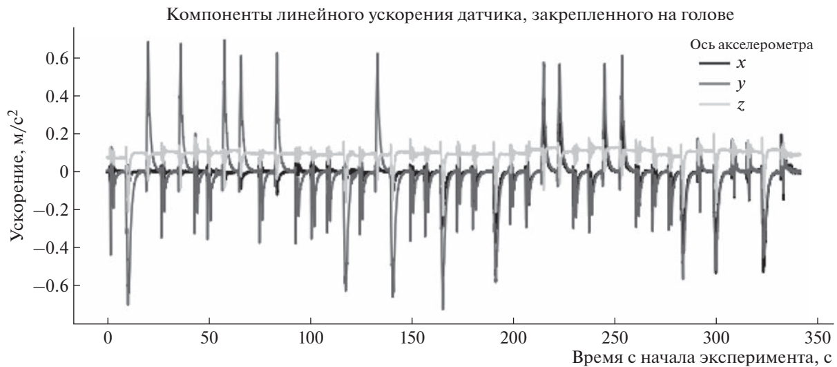
Рис. 6. Компоненты линейного ускорения, действующего на датчик положения, прикрепленный к голове оператора.
