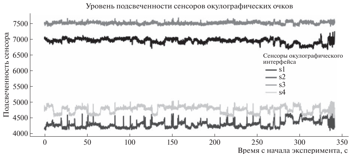
Рис. 2. Не обработанные показания сенсоров, используемые окулографическим интерфейсом для генерации команд управления, где s1 — сенсор, расположенный под глазом, s2 — сенсор над глазом, s3 — сенсор справа от глаза, s4 — сенсор слева от глаза.
