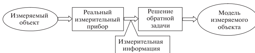
Рис. 1. Общая схема измерений характеристик измеряемого объекта с помощью реальных измерительных приборов.
