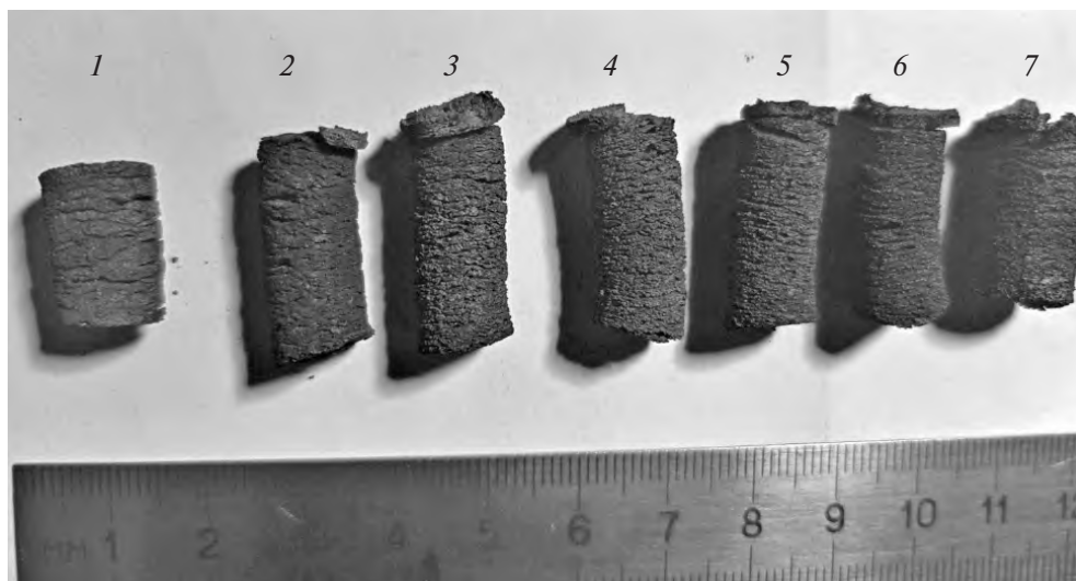
Рис. 9. Фотография образцов продуктов горения исходных смесей 60%(Ti+2B)+40%(Ti+C)+x(5Me) при следующих значениях x: 1 — 0, 2 — 10, 3 — 20, 4 — 30, 5 — 40, 6 — 50, 7 — 60 мас. %.
