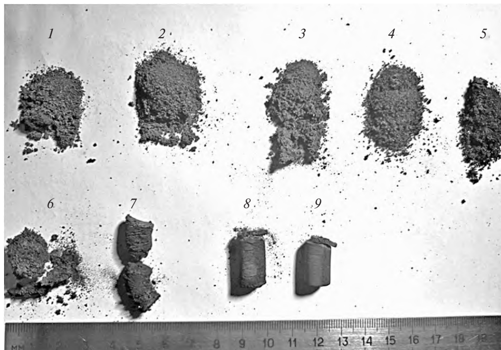
Рис. 6. Фотография образцов продуктов горения активированных смесей 60\%(\text{Ti}+2\text{B})+40\%(\text{Ti}+\text{C})+x(5\text{Me}) , при следующих значениях x : 1 – 0, 2 – 10, 3 – 20, 4 – 30, 5 – 40, 6 – 50, 7 – 60, 8 – 70, 9 – 80 мас. %.
