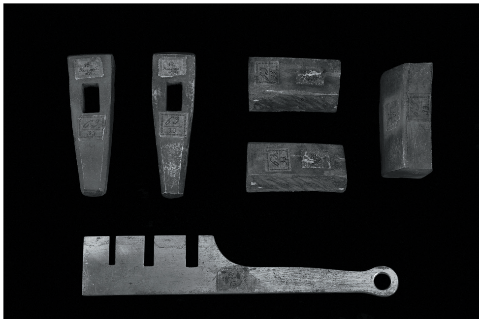
Рис. 2. Инструменты из литой обуховской стали, служившие для изготовления холодного оружия. Златоустовская оружейная и Князе-Михайловская фабрики, 1872 г. (из фондов Горного музея Санкт-Петербургского горного университета, фотография Е. Зотовой)
