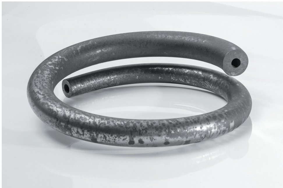
Рис. 3. Ружейный ствол из литой обуховской стали, изогнутый в холодном состоянии. Князе-Михайловская фабрика, 1868–1873 гг. (из фондов Горного музея Санкт-Петербургского горного университета, фотография П. Долганова)
