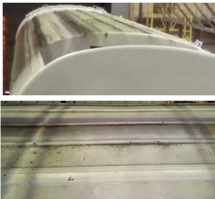
Рис. 4. Деформации обшивки крыши, сохраняющиеся после остывания кузова
