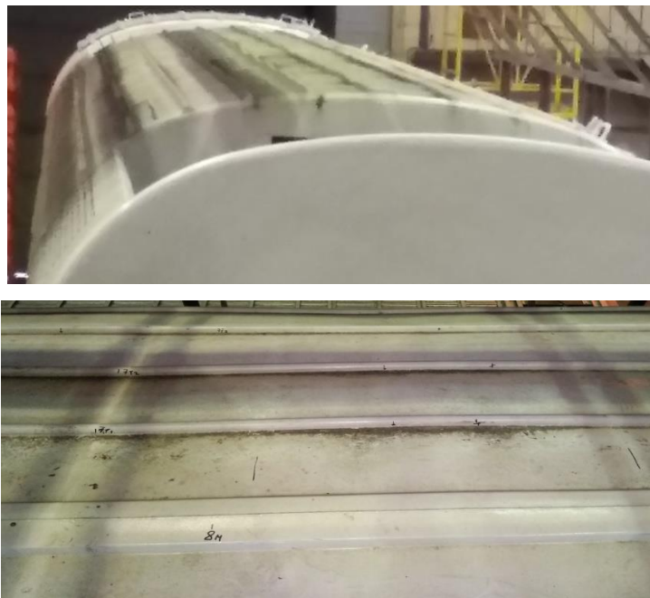
Рис. 4. Деформации обшивки крыши, сохраняющиеся после остывания кузова
